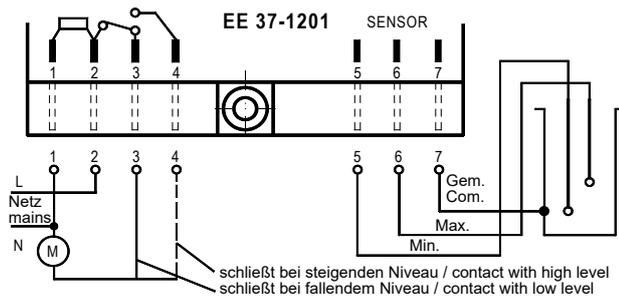
Die "Gem./Com." Elektrode kann mit einem metallischen Flüssigkeitsbehälter oder einer Rohrschlinge verbunden sein. Bei leerem Behälter schaltet das Relais eine Pumpe, die erst abschaltet, wenn der Füllstand die Maximum-Elektrode erreicht hat. Die Pumpe startet erneut, wenn der Füllstand bis zur Minimum-Elektrode gesunken ist.
