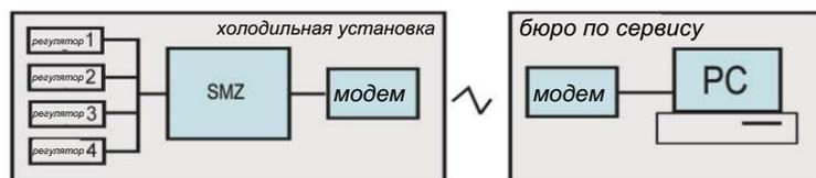
Устройство SMZ x140 имеет внутреннюю систему протоколирования (реестр данных). Она служит для записей результатов измерений и параметров подключенных систем регуляторов и их передачи в локальный компьютер или модемом в дистанционный компьютер.
