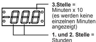
Beim Typ 1380-2 erfolgt die Eingabe der Abtaue-Schaltzeiten bei P24-P27, die Sollwert-Umschaltung bei P05/P06. Die Schaltzeiten können jeweils deaktiviert werden (Display zeigt dann "OFF").
