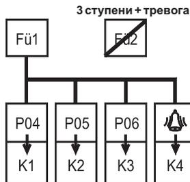
Таким образом выполняется трехступенчатый регулятор, реле 4 конфигурируется, как предупредительное реле на основании подключения к постоянному току. Вход датчиков 2 – не активный.
