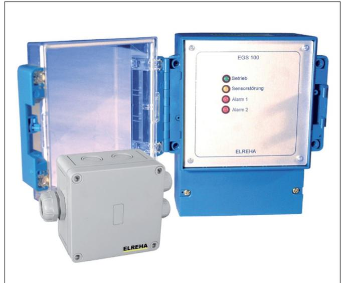
**i** Die Sensoren der EGS Leckwarner sind für die Kältemittel/Fluorkohlenwasserstoffe R-134a spezifiziert, besitzen aber Querempfindlichkeiten zu anderen FKW und Stoffen. Sie reagieren daher auf Kältemittel mit ähnlichen Bestandteilen, wie z.B. R-22, R-404A, R-407C, R-407F, R-417A, R-449A und R-507. Empfindlichkeiten und Eckwerte der Reaktion können aber abweichen.
