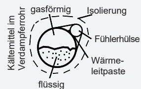
**Sorgen Sie durch eine gute Schaumstoff-Isolation dafür, dass keiner der beiden Fühler im Luftstrom liegt.**
