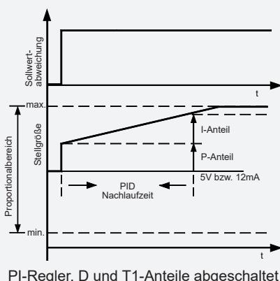
PI-Regler, D und T1-Anteile abgeschaltet
