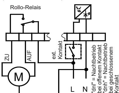
Mit Aktivieren des Digitaleingangs zieht das Relais an und fährt das Rollo über den Schließerkontakt zu. Nach de-aktivieren des Digitaleingangs fällt das Relais ab und öffnet über seinen Öffnerkontakt das Rollo.
