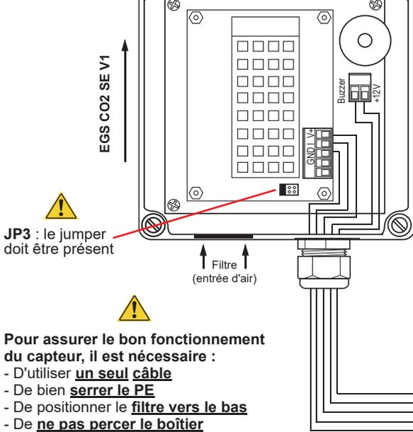
**Pour assurer le bon fonctionnement du capteur, il est nécessaire :**
